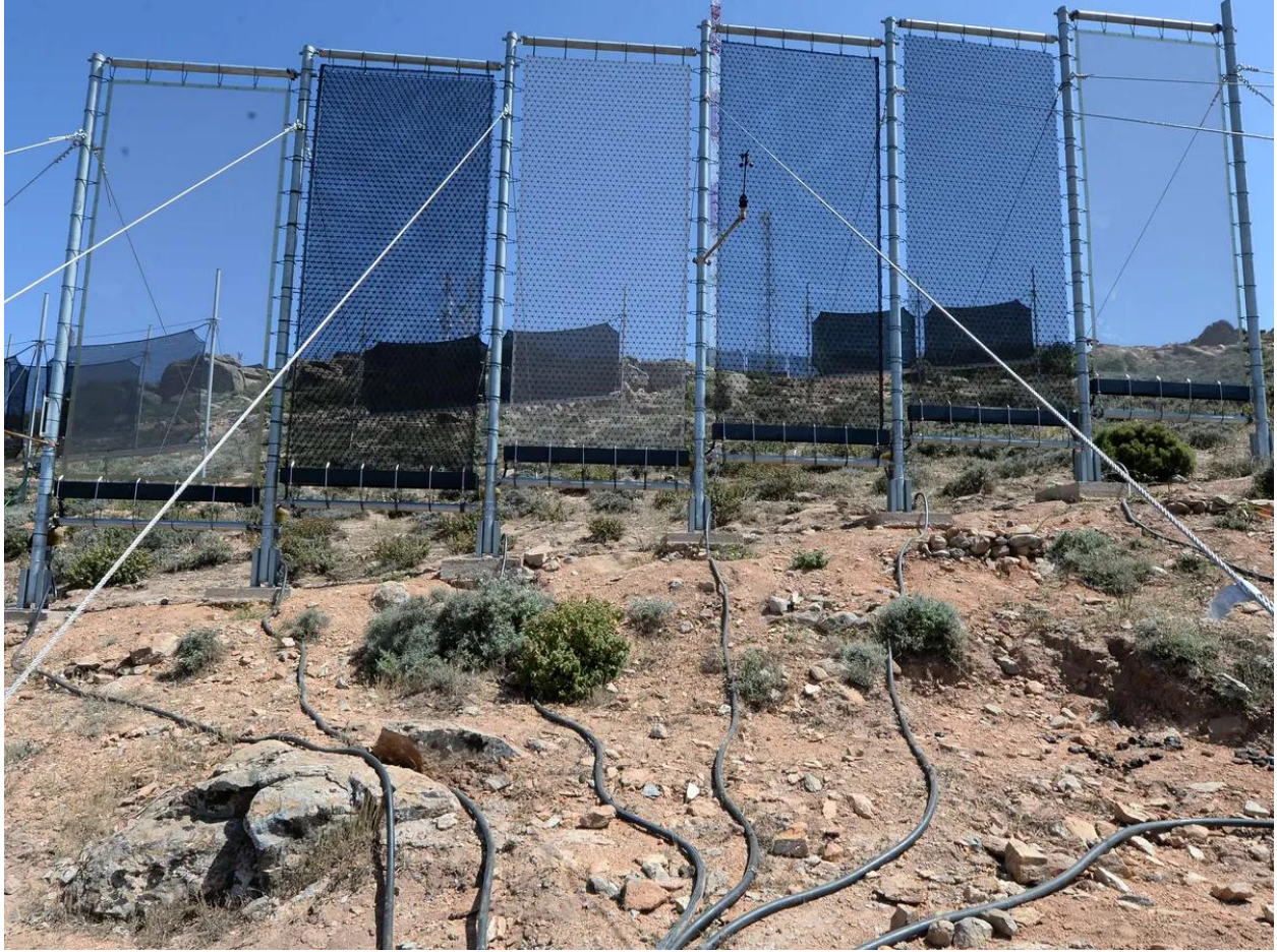
صورة توضح تقنية حصاد الضباب لإحدى القرى النائية في المغرب. المصدر: Alarabya.net
